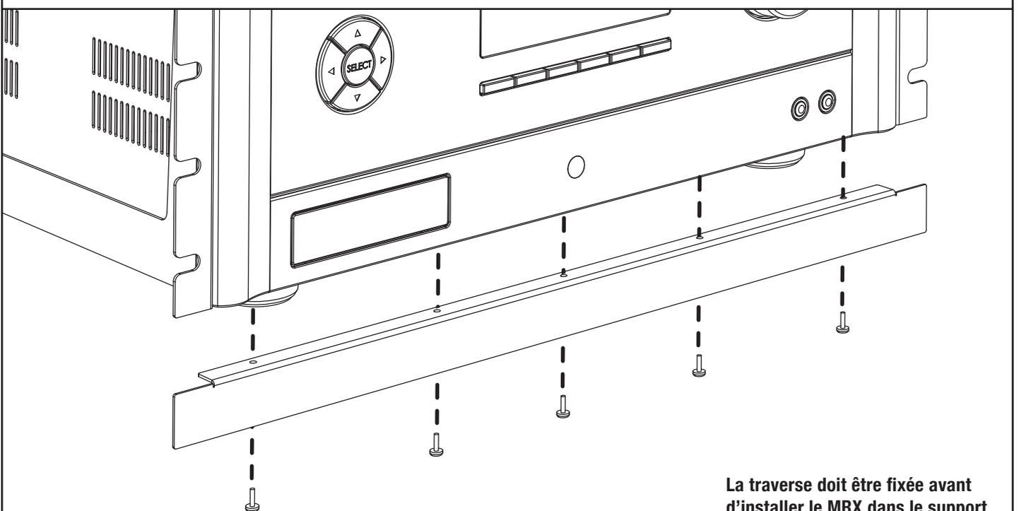
La traverse doit être fixée avant d'installer le MRX dans le support.
